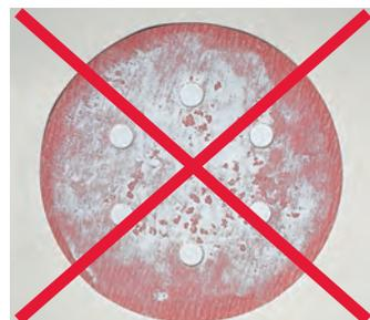
Malgré le temps de séchage plus long des autres produits, seule la surface est séchée et le disque à poncer s'encrasse.
