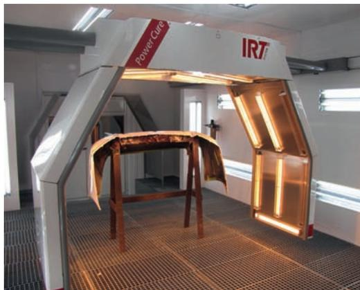
Les pièces détachées sont faciles à polymériser. Le PowerCure détecte la position de départ puis économise de l'énergie en n'activant que les lampes IR nécessaires.
