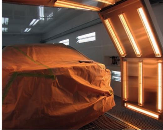
Le PowerCure se déplace automatiquement au bon endroit en fonction des éléments choisis.
