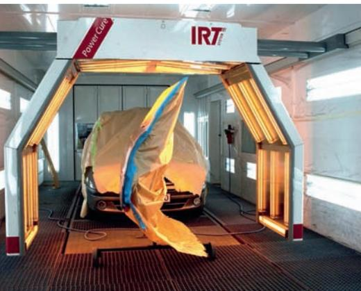
Le véhicule et les pièces détachées peuvent être polymérisés lors du même cycle de séchage grâce à notre technologie avancée.
