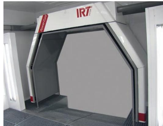
Un élément type est durci en 5 minutes. Laisser refroidir la voiture 5 minutes supplémentaires. Elle peut ensuite être sortie de la cabine de pulvérisation, et le traitement peut se poursuivre. Par conséquent, l'IRT PowerCure vous procure une capacité de séchage améliorée car il transforme votre cabine traditionnelle en cabine de polymérisation rapide.
