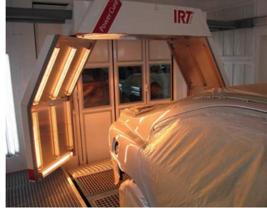
L'avant et l'arrière du véhicule sont faciles à polymériser car les ailes peuvent être orientées vers la surface peinte.
