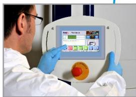
Unité de pilotage avec écran tactile intuitif sur bras déporté ou sur façade armoire de puissance électrique.
